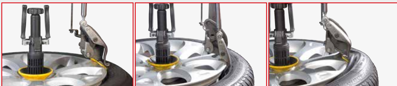
Procedura di smontaggio del tallone superiore
