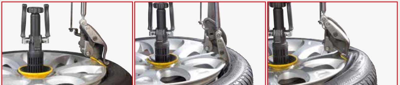
Procedimiento de desmontaje del talón superior
