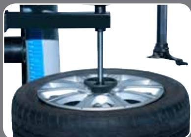
● Le **GRAND DISQUE** permet de soulever le pneu et de détacher le talon inférieur. ● **EL DISCO GRANDE** permite la elevación del neumático y la desconexión del talón inferior. ● O **DISCO GRANDE** permite a elevação do pneu e a separação do talão inferior.
