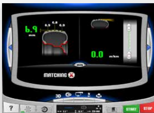
Profondeur de la bande de roulement et dérive de la roue
