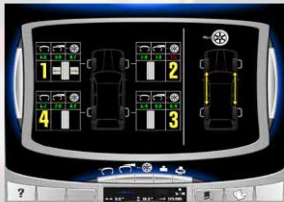
**Spezielles Diagnosegerät** des Fahrzeuggradsatzes zur Prüfung der Abnutzung der Reifenlauffläche, der Abweichungswinkel, der Radunrundheit und der Unwuchten.
