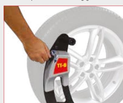
Prédisposée pour le branchement direct aux élévateurs de roues TT-ZERO GRAVITY (automatique) et TT-R (manuel), qui annulent l'effort de l'opérateur, accélèrent les opérations quotidiennes et garantissent un centrage parfait.
