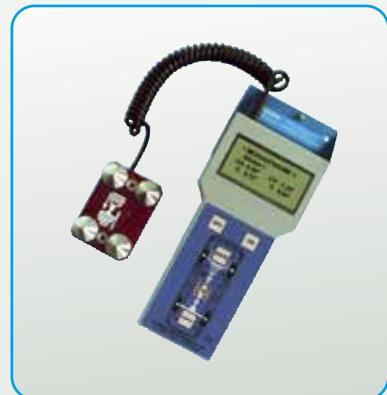
➤ Predisposto per utilizzo inclinometro ROMESS CM09606 per misura altezze telaio
