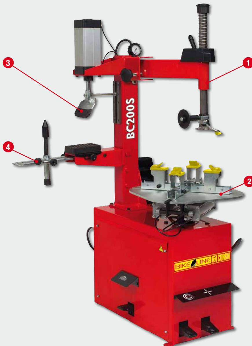
Desmontadora de neumáticos semiautomática línea MOTO ideal para un uso profesional e intensivo en neumáticos de moto, scooter, kart, máquinas para jardinería, pero también en ruedas de gran espesor como los neumáticos de quad.
