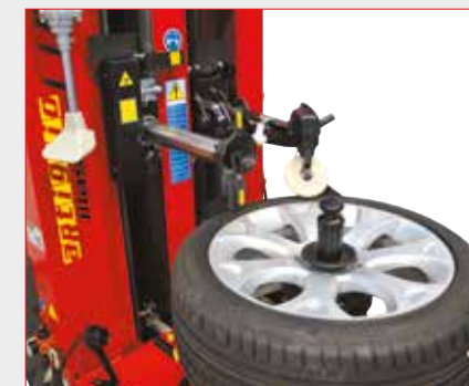
Posicionamento automático das ferramentas para ciclo manual
