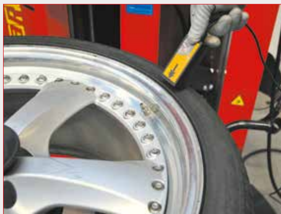
instrumento para detectar sensor e dados relativos
