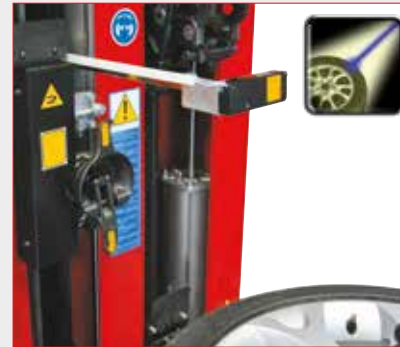
Teach-in-Verfahren der Raddaten und automatische Arbeitsabläufe
