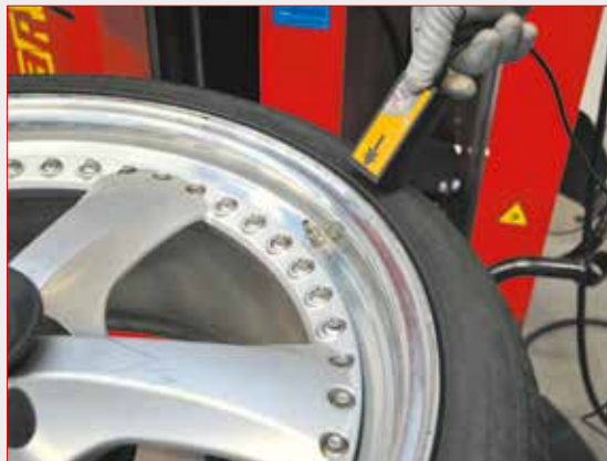
Instrument für die Überwachung des Sensors und der entsprechenden Daten
