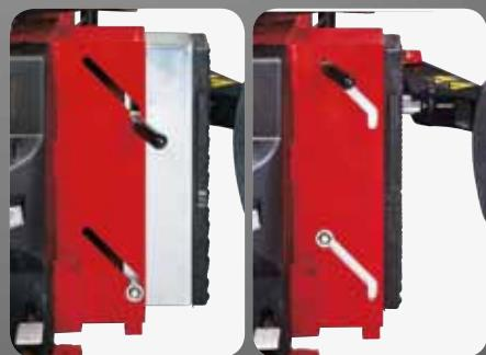
**3** El grupo destalonador cuenta con apoyo llanta telescopico de dos posiciones (patente CORGHI) para destalonar todo tipo de ruedas con anchura máxima de hasta 14". **3** O grupo descolador de pneus tem o apoio da jante telescópico com duas posições (patente CORGHI) para descolar todos os tipos de rodas para uma largura máxima de 14".
