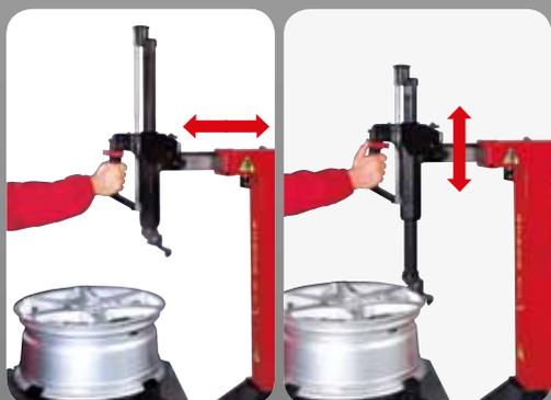
**2** **Bloqueo neumático simultáneo** del brazo horizontal y de aquél vertical porta-torreta, con posicionamiento automático de la torreta en la posición ideal de trabajo.
